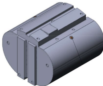
Рисунок 1 – Понтон 1240x1200x940 мм
