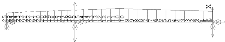
Рисунок 3 - Скінчено-елементна модель бортового перекриття із прикладеним навантаженням
