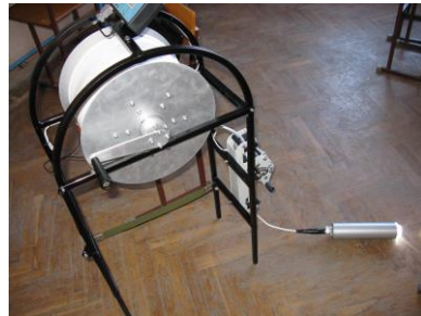
Підводна опускаюча відеокамера, 2018
