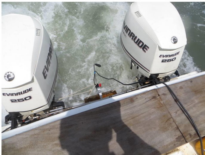
Рис. 1. Приклад розташування датчиків ехолоту
