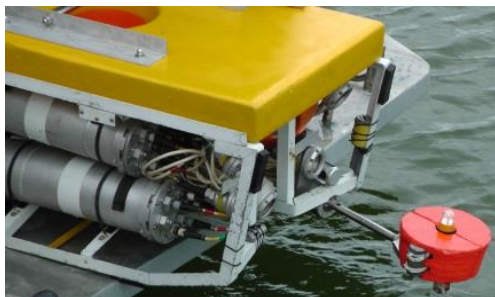
Встановлення маяка для виявленого затонулого об'єкта
