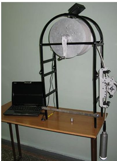
Рис.4 – Погружна відеокамера ПСВ-62/150
