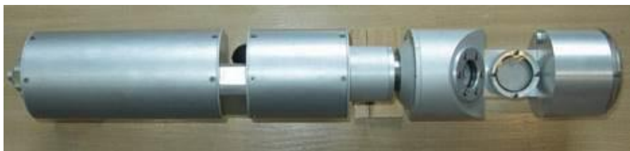
Рис.2 – Погружна відеокамера ПСВ-90/100
