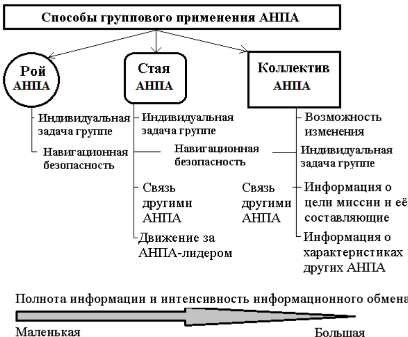
Рисунок 2 – Способы реализации технологий группового применения АНПА
