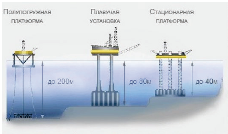
Рисунок 1 – Основні типи морських стаціонарних платформ
