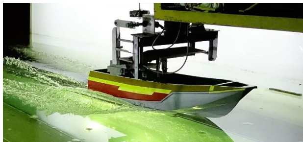
Рисунок 5 – Модель катера в басейні (а) та залежність гідродинамічного опору від швидкості судна (б).
