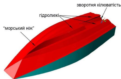
Рисунок 4 – Проекція «корпус» теоретичного креслення (а) та зовнішній вигляд (б) швидкісного судна з гібридними обводами.
