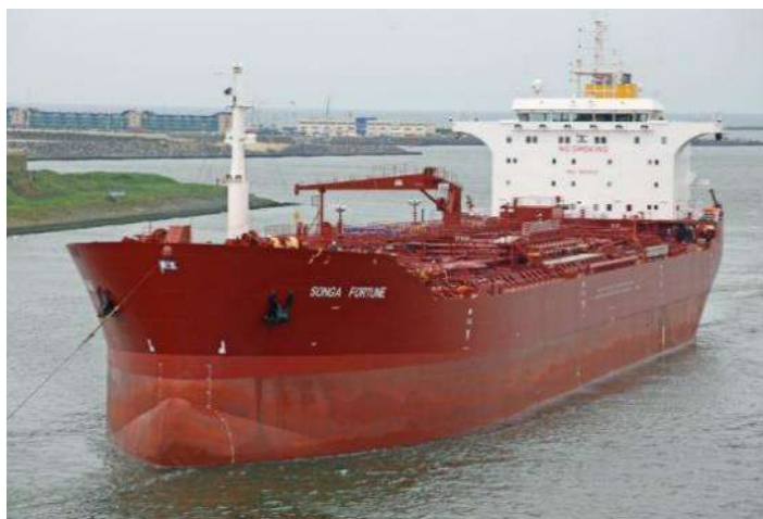
Рисунок 6.2 – Танкер дедвейтом 45500 т з ГД MAN 6S50ME-B9.3
