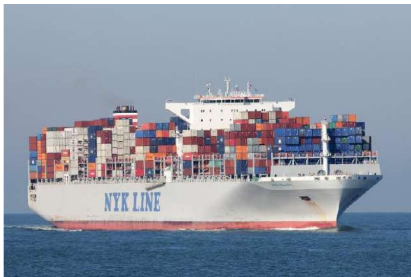
Рисунок 6.4 – Контейнеровоз дедвейтом 122000 т з ГД MAN 12S90ME-C9.2
