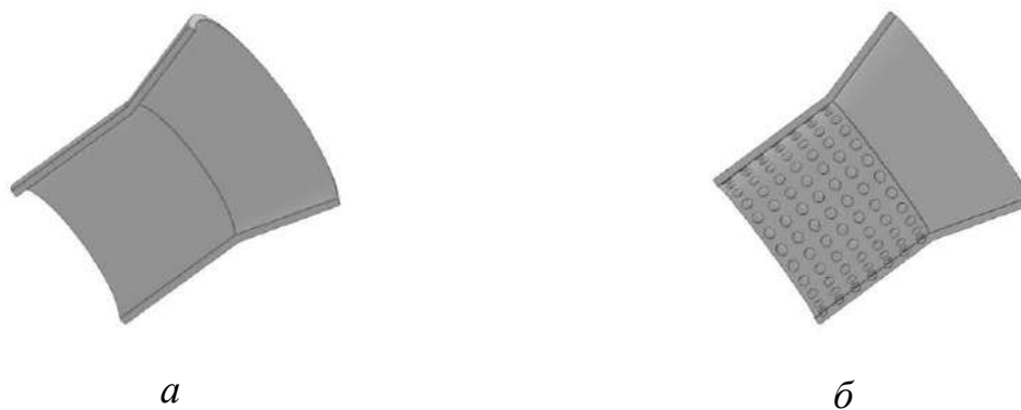
Рисунок 6.13 – Розташування лункових систем на дифузорному соплі: а – базовий варіант; б – варіант с лунковими системами
