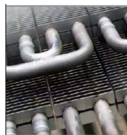
Рисунок 1.32 – Типи оребрених поверхонь нагріву утилізаційних котлів [70]
