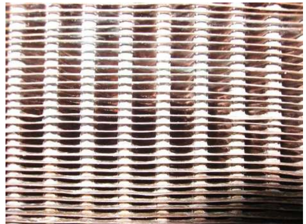
Рисунок 2.9 – Зовнішній вигляд ОНП ( a ) та поверхні теплопередачі ( б ); матеріал оребрення та теплопередавальних труб і підведення води – мідь; з'єднання – паяння оловом
