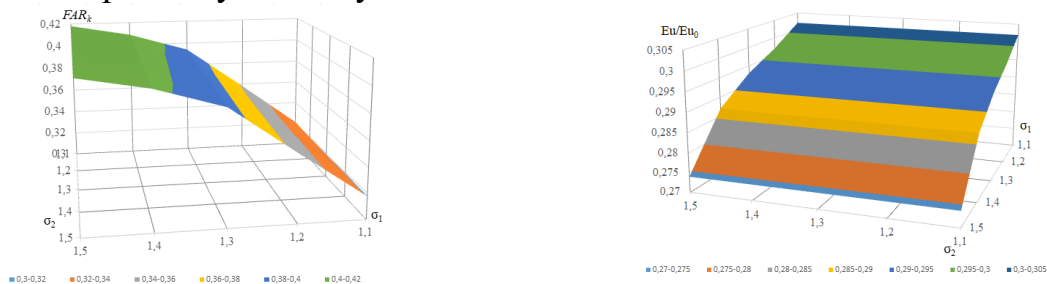
Рисунок 12 – Теплогідрравлічна ефективність теплопередачі в гладкій еліптичній поверхні
