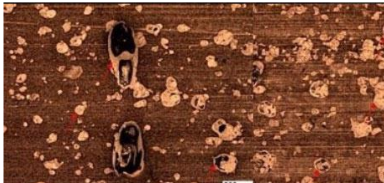
Рисунок 1.5 – Наслідки впливу синфазних напруг та струмів в ЧРАЕП
