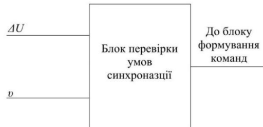
Рисунок 8 – Структурна схема блоку перевірки умов синхронізації
