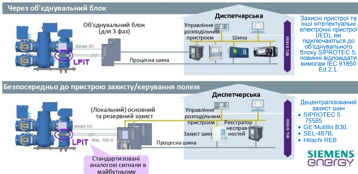
Рисунок 3 – Шляхи до технологій захисту та наведення: через об'єднаний підрозділ і безпосередньо до пристрою захисту/керування полем
