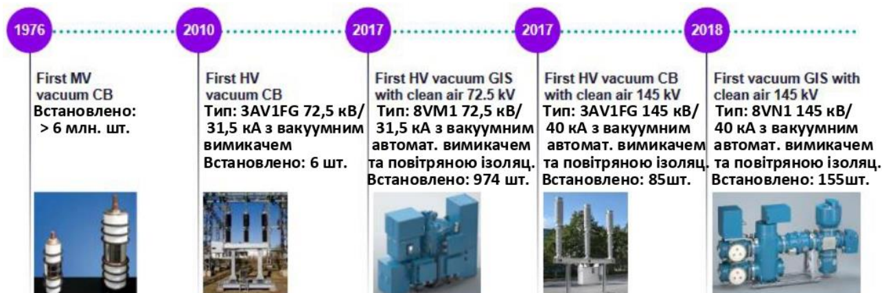
Рисунок 1 – Еволюція вакуумних вимикачів компанії Siemens Energy
