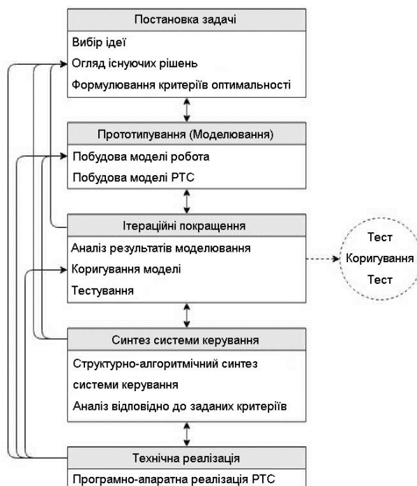
Рисунок 1 – Структура процесу дослідження та синтезу РТС
