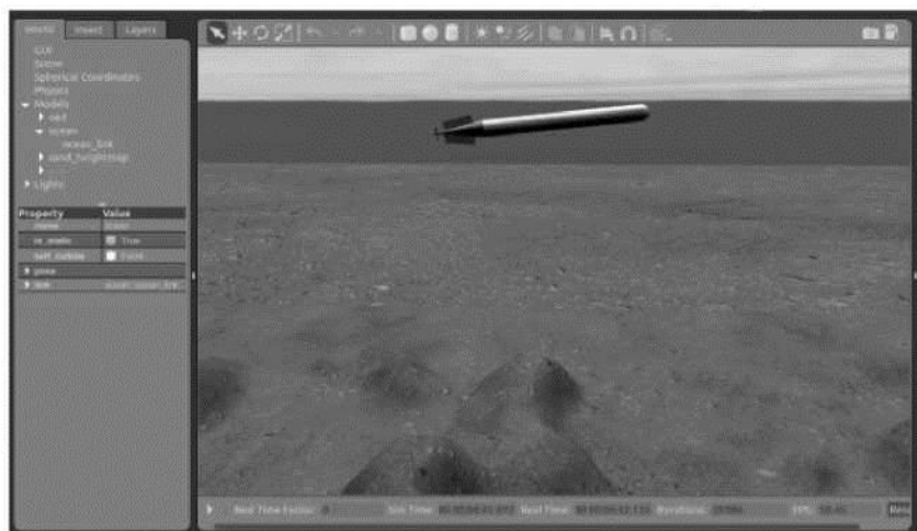
Рисунок 3 – Модель АНПА у віртуальному світі, реалізовані у пакеті моделювання Gazebo
