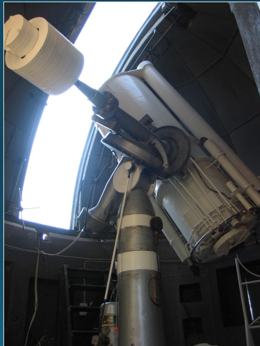
702 мм телескоп-рефлектор системи Кассегрена
