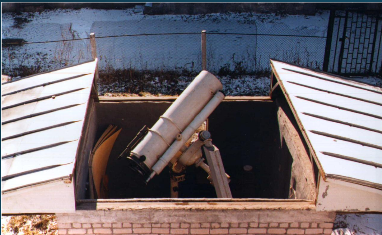
400 мм телескоп-рефлектор системи Річчі-Кретьєна
