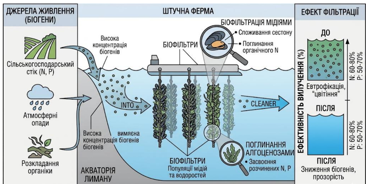
Рис. 1.3 – Схема фільтрації джерел живлення за допомогою штучних ферм [21]
