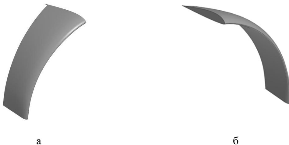
Рисунок 4.8 – Виготовлені методом 3D-друку моделі дугового крила буксированого РБ: а – права несуча поверхня; б – ліва несуча поверхня
