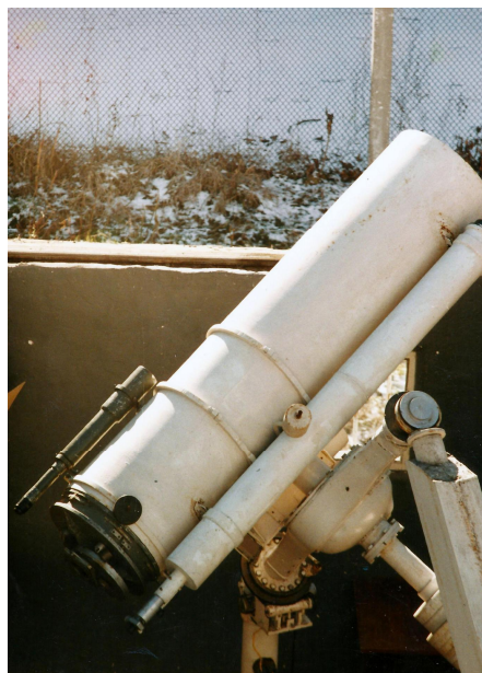
Телескоп системи Річі-Кретьєна D= 400мм
